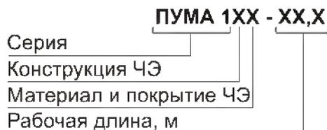
1.1.9 Пример обозначения при заказе и (или) в другой документации преобразователя уровня со стержневым чувствительным элементом из нержавеющей стали 12Х18Н10Т длиной 1,5 м:
