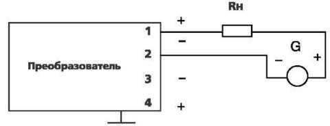
Вариант включения для преобразователей Сапфир-22МП1- ДУ-Ех с выходным сигналом 4-20 мА при двухпроводной линии связи.
