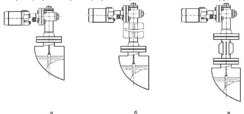
Установка на выносной камере: a) без радиатора; б) с радиатором; в) с радиаторов в виде отдельного патрубка
