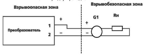
Вариант включения для преобразователей с выходным сигналом 0-5 мА или 0-20 мА при четырехпроводной линии связи.
