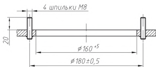
Эскиз доработки крышки резервуара для установки ППП
