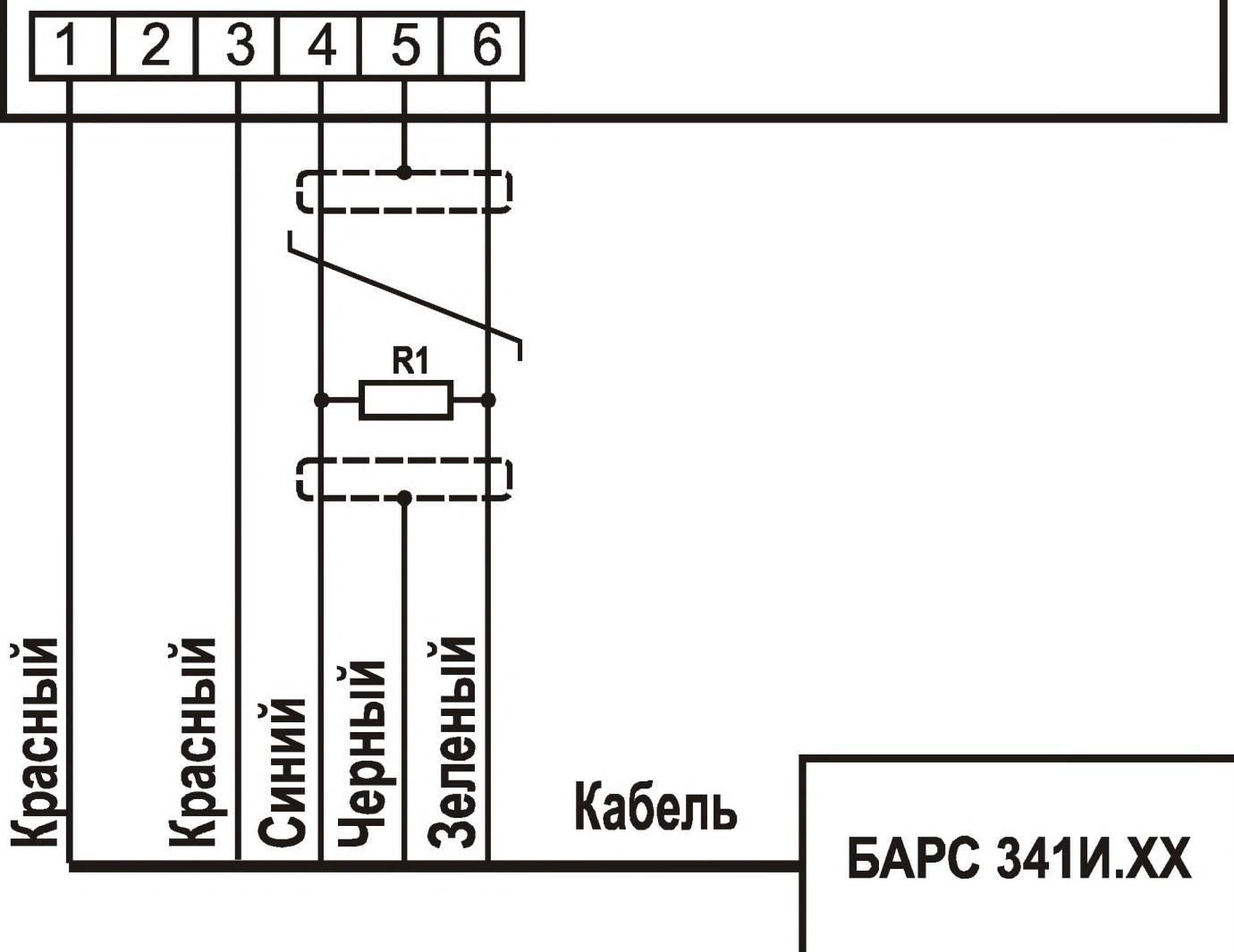
Рисунок Ж.1 – Схема электрическая подключения радиоволнового преобразователя уровня БАРС 341И.ХХ ТУ 4214-020-12196008-02 к прибору
