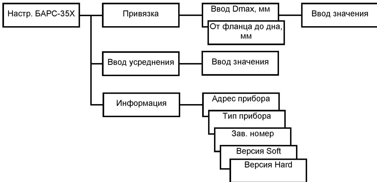
Рисунок К.2 – Меню настроек радиоволновых преобразователей уровня исполнений БАРС 351И.00, БАРС 351И.02...БАРС 351И.18 и исполнений БАРС 352И.00, БАРС 352И.02...БАРС 352И.18
