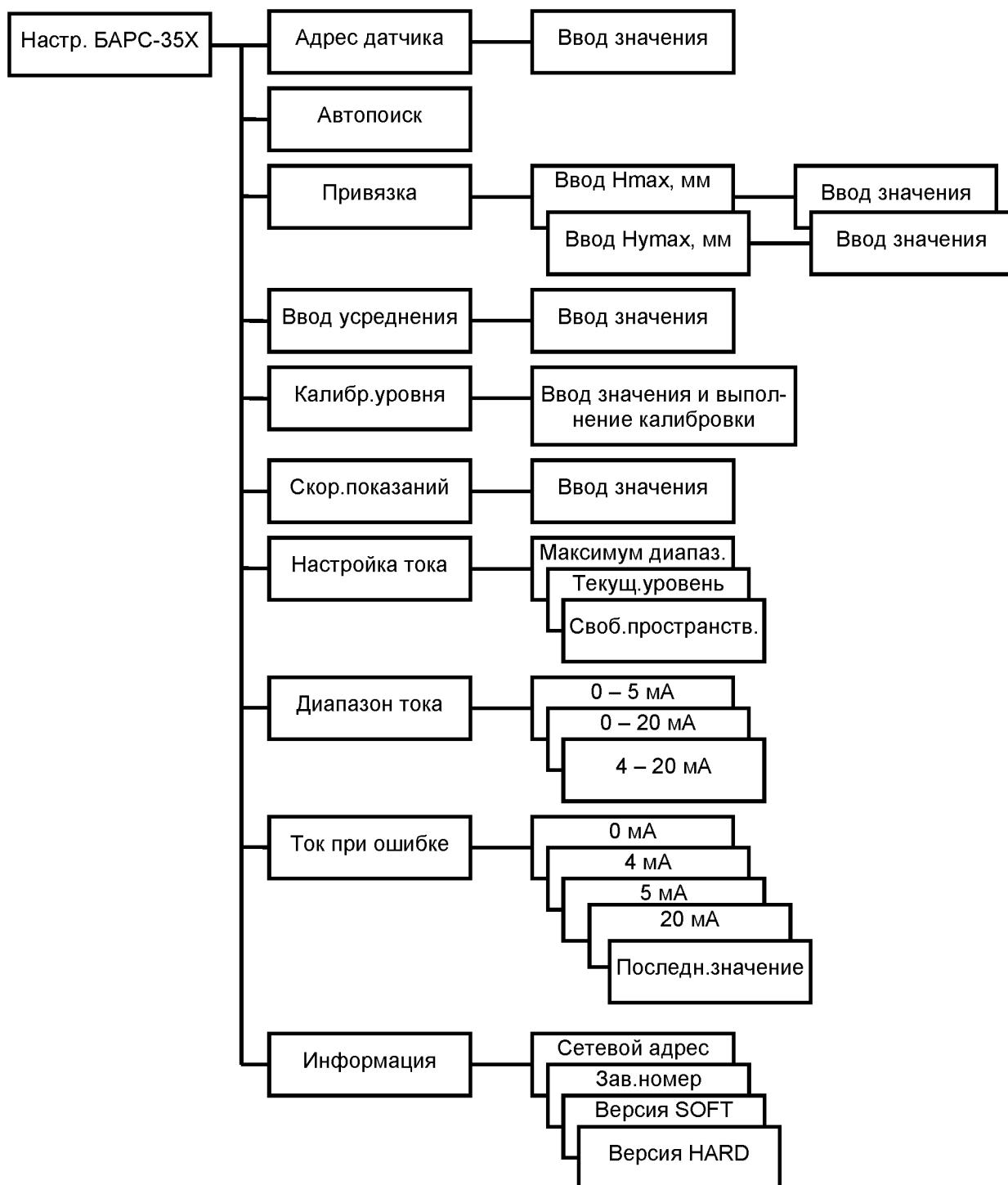
Рисунок Л.2 – Меню настроек радиоволнового преобразователя уровня исполнений БАРС 351И.20, БАРС 351И.22... БАРС 351И.38; БАРС 352И.20, БАРС 352И.22... БАРС 352И.38
