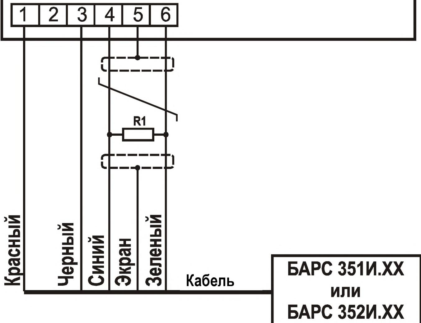
Рисунок К.1 – Схема подключения радиоволновых преобразователей уровня исполнений БАРС 351И.00, БАРС 351И.02... БАРС 351И.18 и исполнений БАРС 352И.00, БАРС 352И.02... БАРС 352И.18 к прибору
