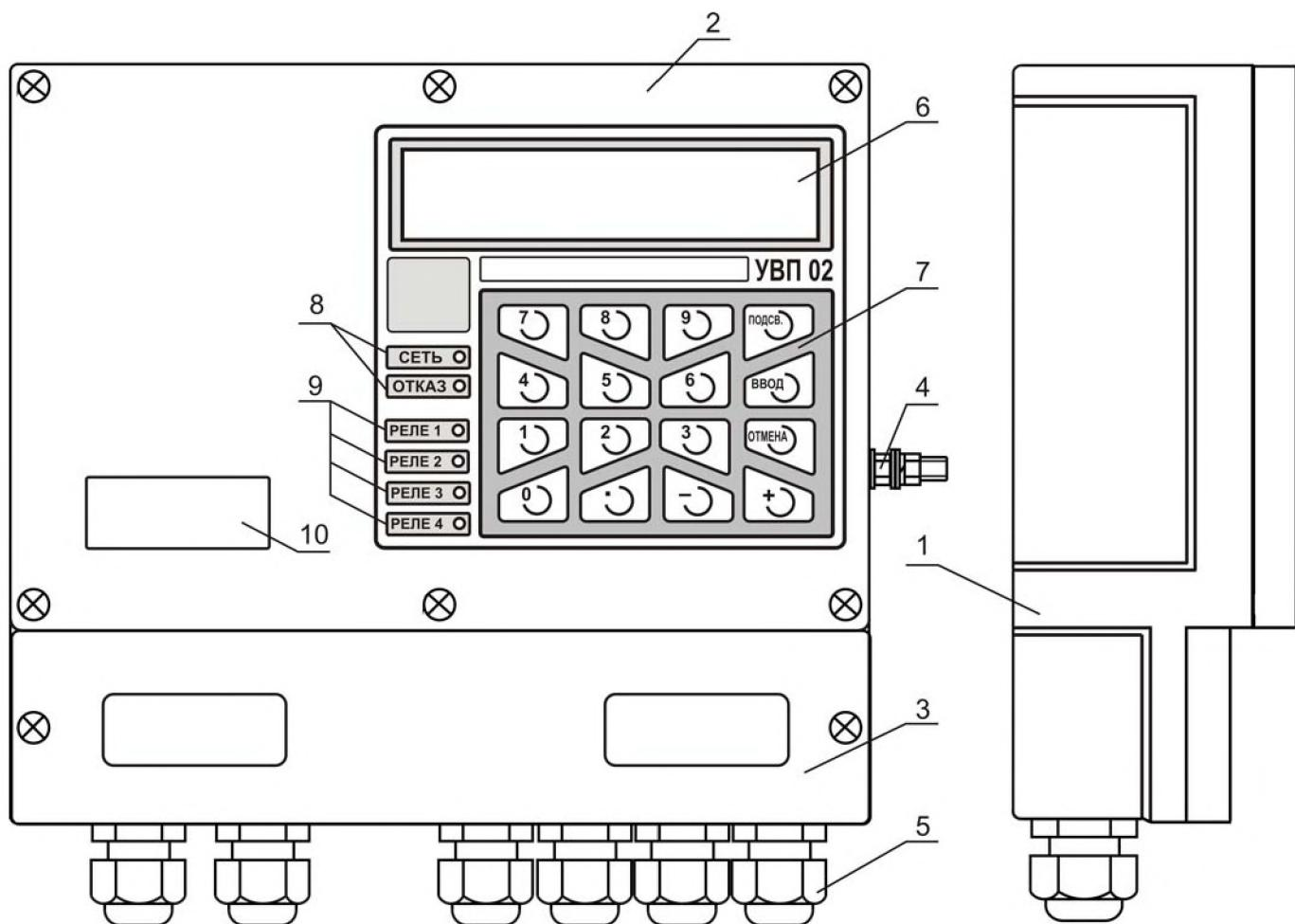
Рисунок 1 – Преобразователь вторичный универсальный УВП 02
