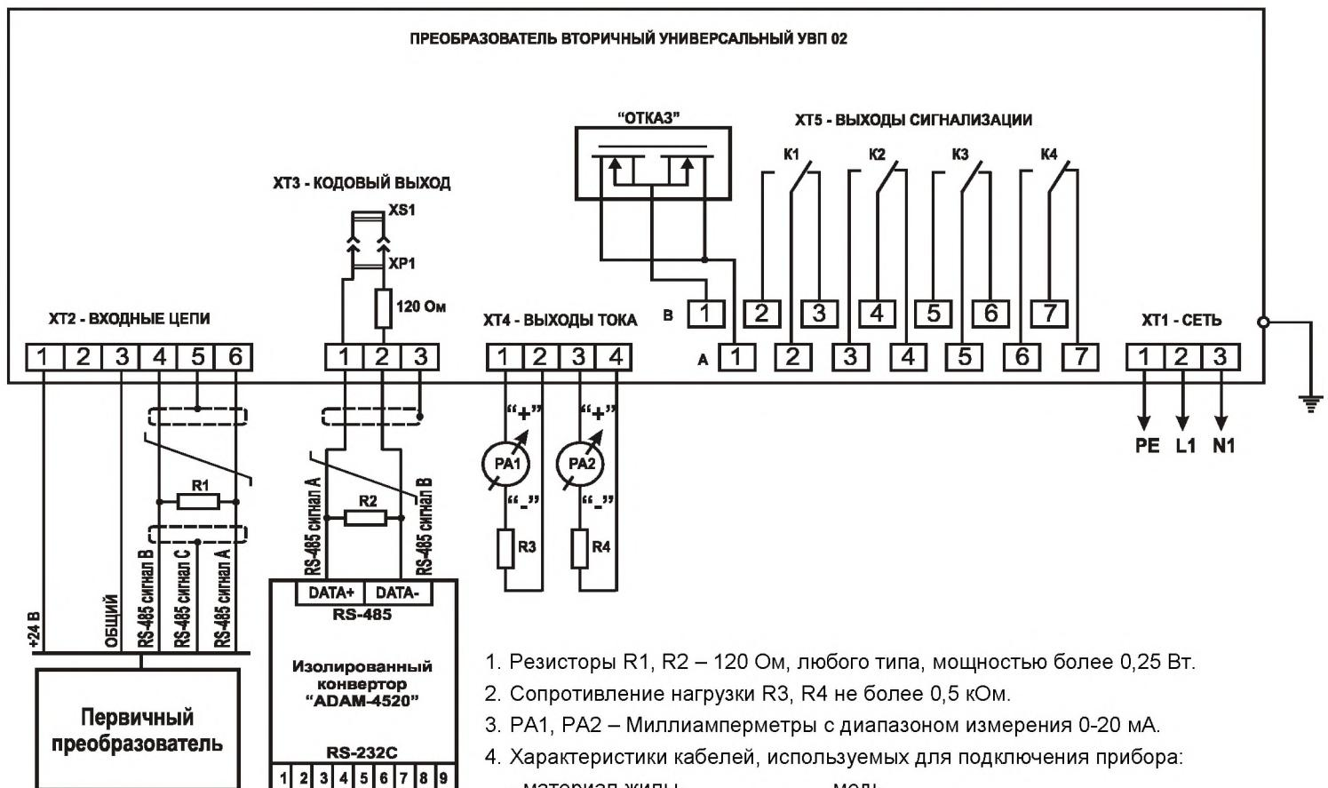
1. Резисторы R1, R2 – 120 Ом, любого типа, мощностью более 0,25 Вт.
