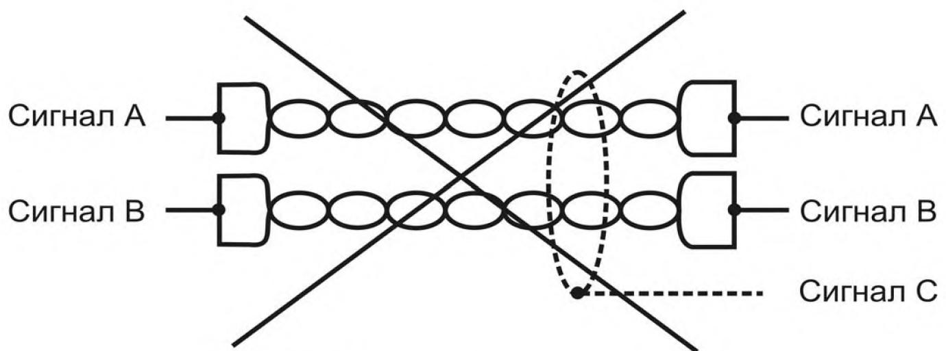
Рисунок В.7 - Неправильное подключение к витой паре
