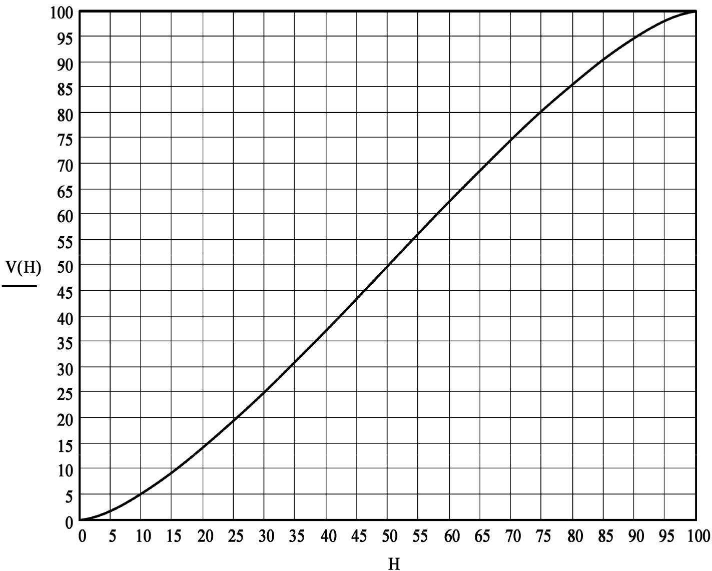
Рисунок 2 – Тарировочная характеристика горизонтальной цилиндрической емкости.
