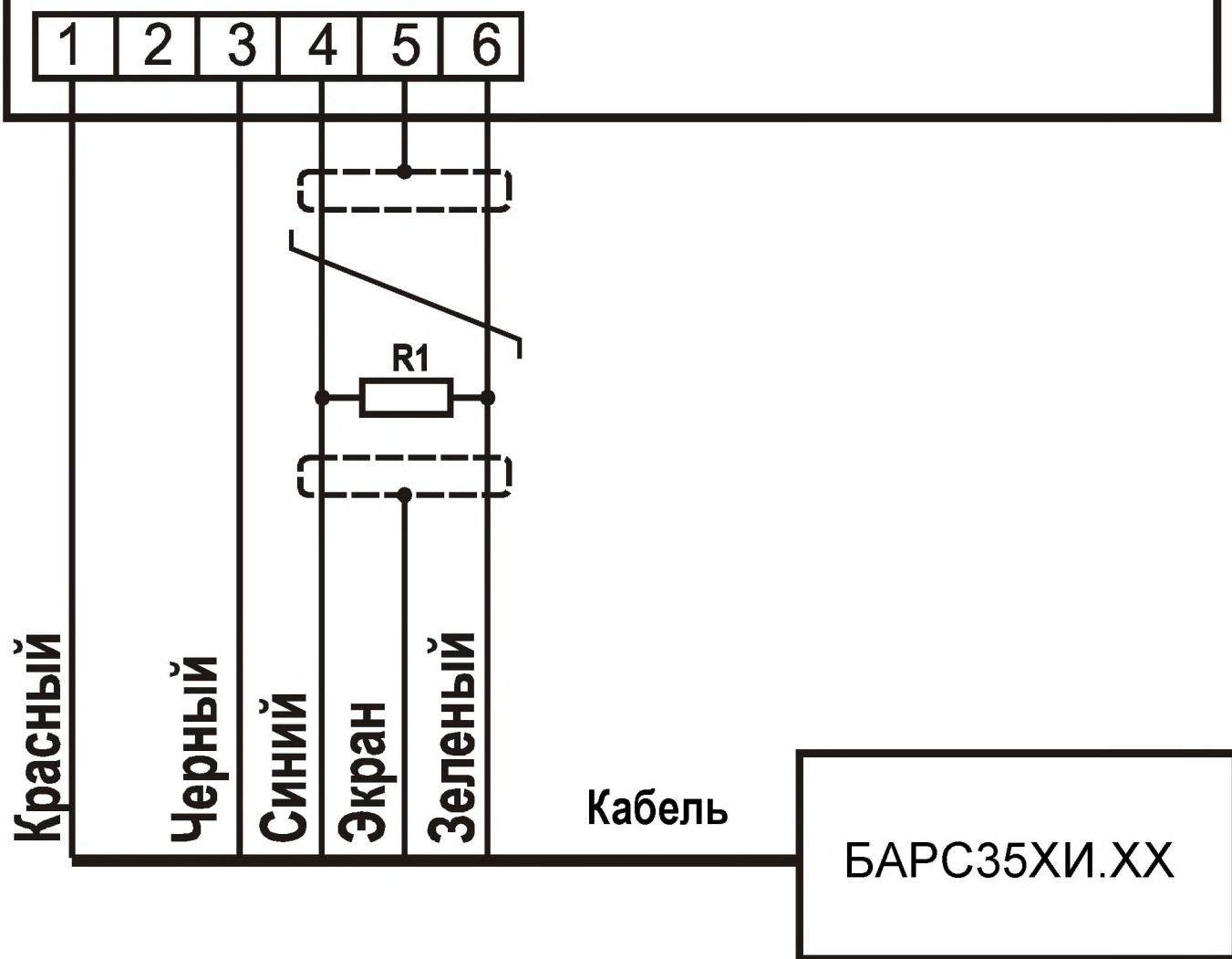
Рисунок Л.1 – Схема подключения радиоволнового преобразователя уровня
