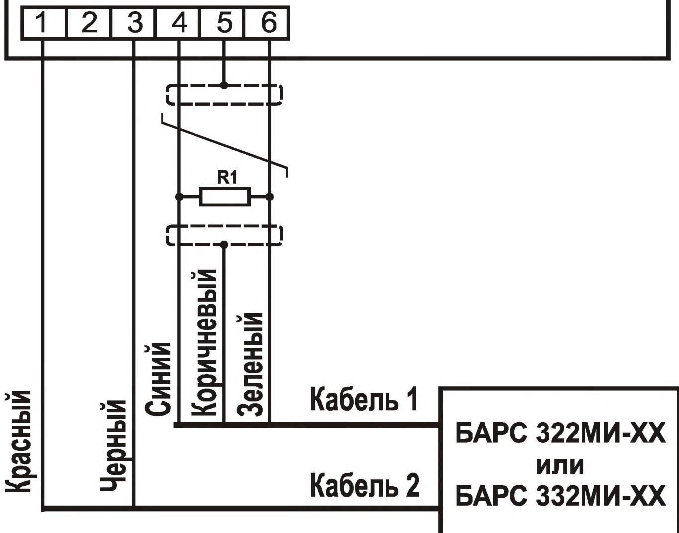
Рисунок И.1 – Схема электрическая подключения радиоволновых уровнемеров БАРС 322МИ-ХХ и БАРС 332МИ-ХХ к прибору
