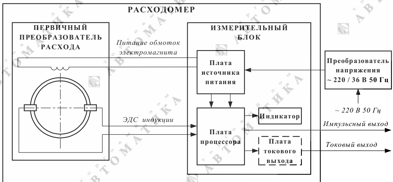
Рис. 1. Структурная схема расходомера.
