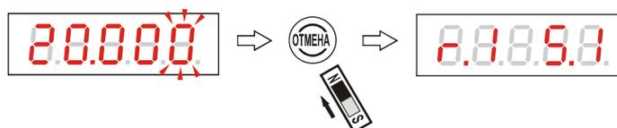
Рисунок 46 - Отмена ввода значения уставки 1 реле 1
