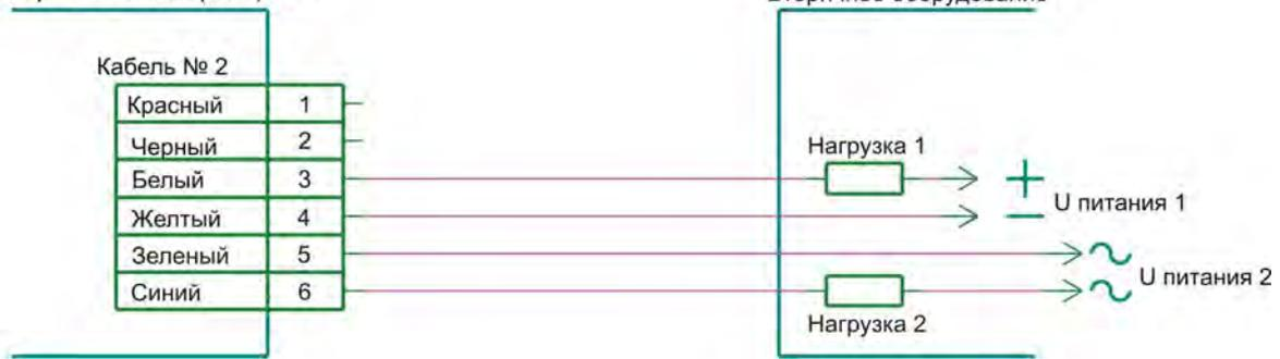
Рисунок Б.3 – Пример подключения цепей релейных выходов
