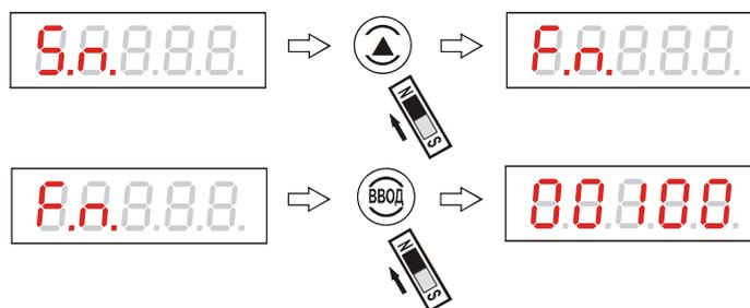
Рисунок 70 - Просмотр заводского номера урвнемера
