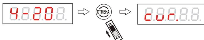
Рисунок 79 - Выход из подраздела выбора диапазона токового выхода
