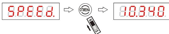
Рисунок 86 - Переход к режиму измерения без записи установочных параметров
