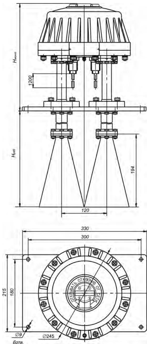
Рисунок 10 - Габаритные и установочные размеры уровнемера исполнений БАРС 322МИ-03, БАРС 322МИ-04, БАРС 332МИ-03
