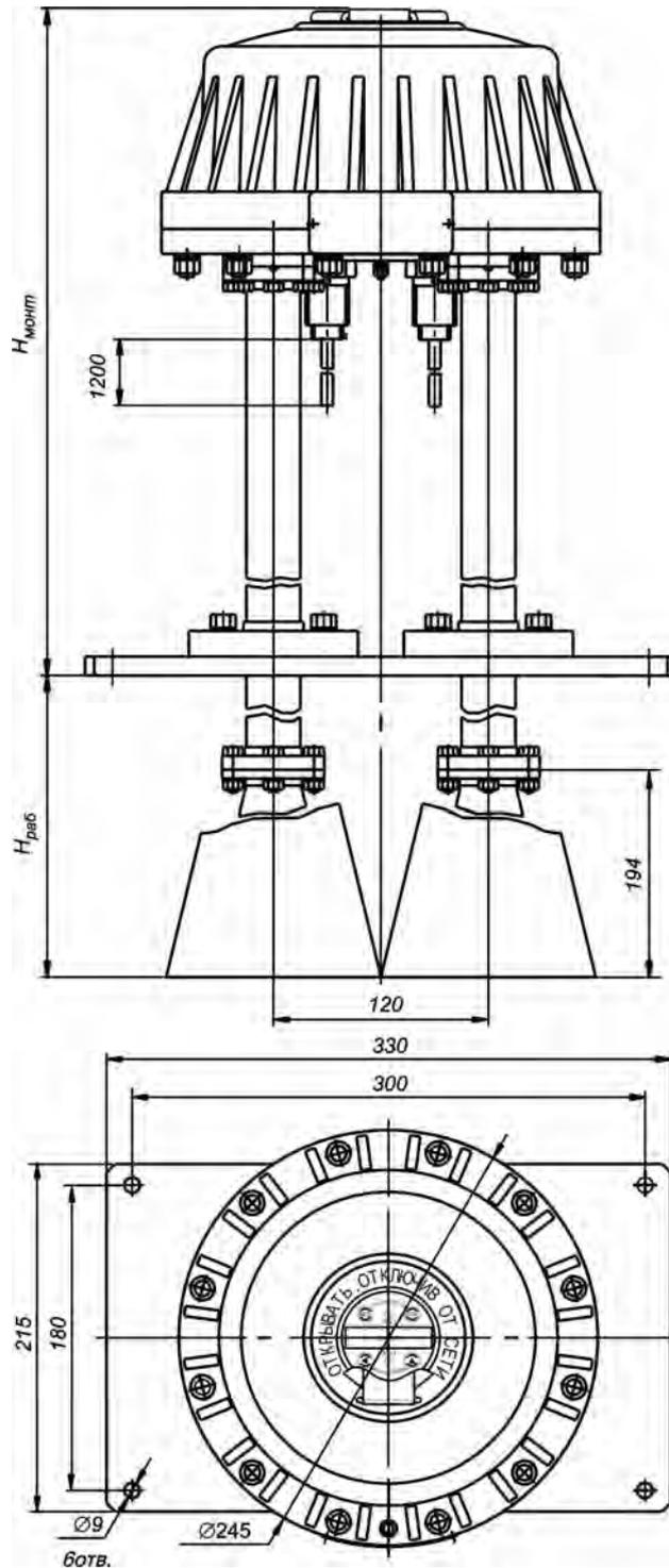
Рисунок 12 - Габаритные и установочные размеры уровнемера исполнений
