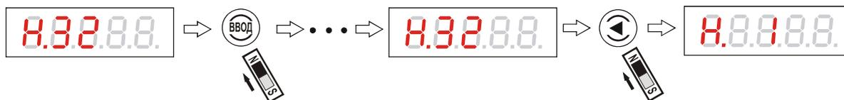
Рисунок 65 - Переход к повторному вводу тарифовочной таблицы при обнаружении уровнемером ошибок ввода
