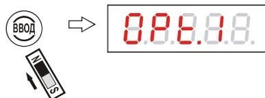
Рисунок 32 - Вход в режим программной настройки уровнемера
