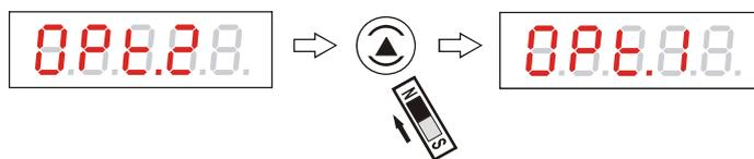
Рисунок 34 - Переход между режимами программной настройки уровнемера
