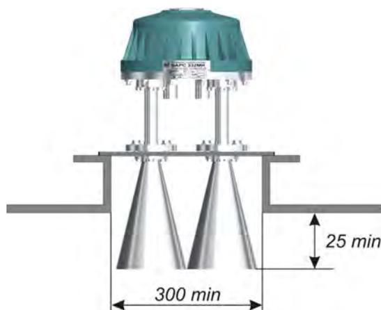
Рисунок 18 – Пример установки уровнемера исполнений БАРС 332МИ-02, БАРС 332МИ-04, БАРС 332МИ-06
