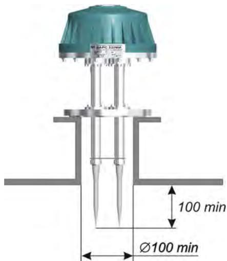
Рисунок 19 – Пример установки уровнемера исполнений
