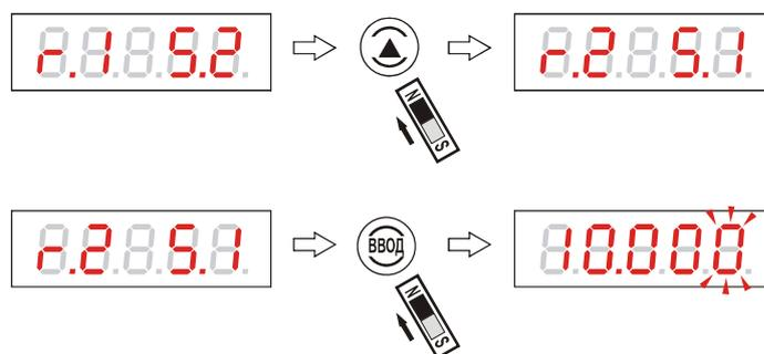
Рисунок 49 - Переход к вводу значения уставки 1 реле 2
