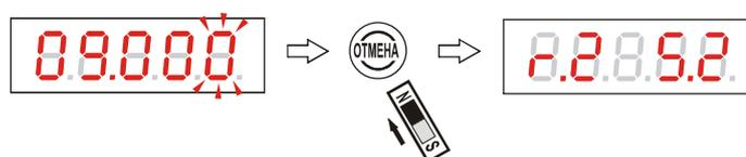
Рисунок 52 - Отмена ввода значения уставки 2 реле 2
