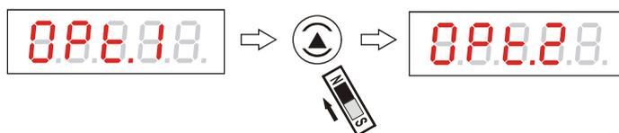
Рисунок 33 - Переход между режимами программной настройки уровнемера
