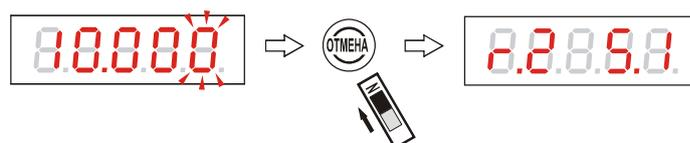
Рисунок 50 - Отмена ввода значения уставки 1 реле 2
