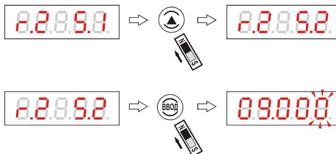
Рисунок 51 - Переход к вводу значения уставки 2 реле 2
