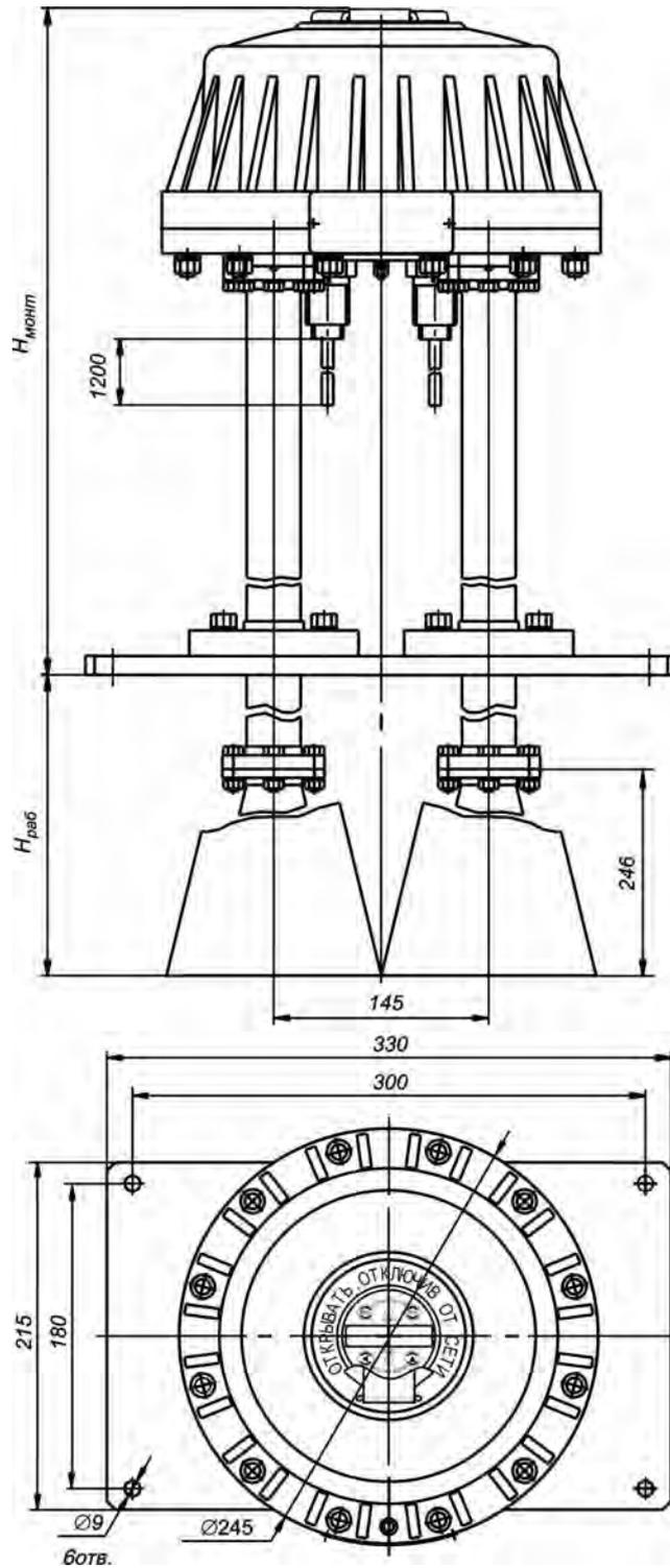
Рисунок 13 - Габаритные и установочные размеры уровнемера исполнения БАРС 332МИ-06
