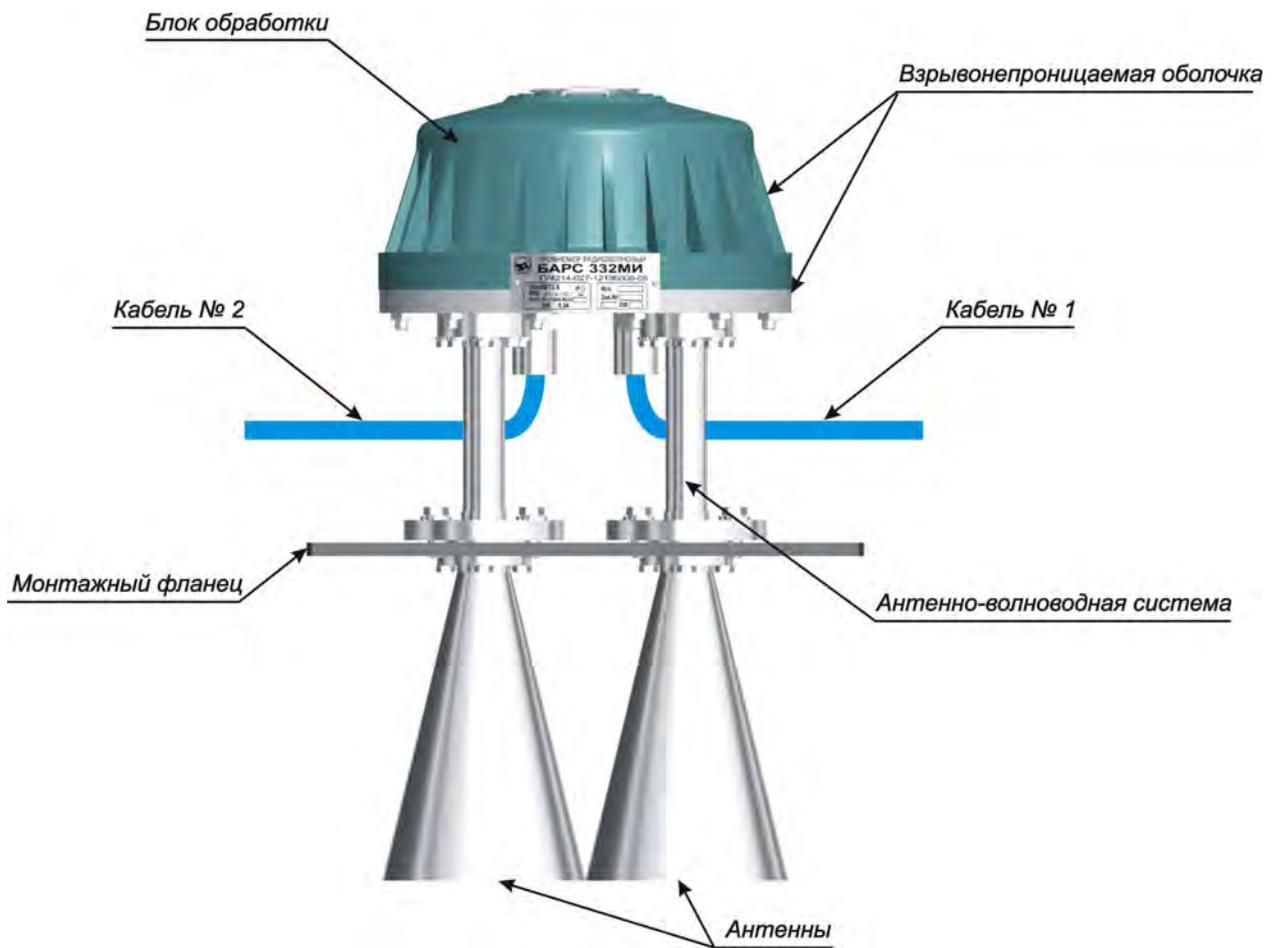
Рисунок 2 - Составные части уровнемера
