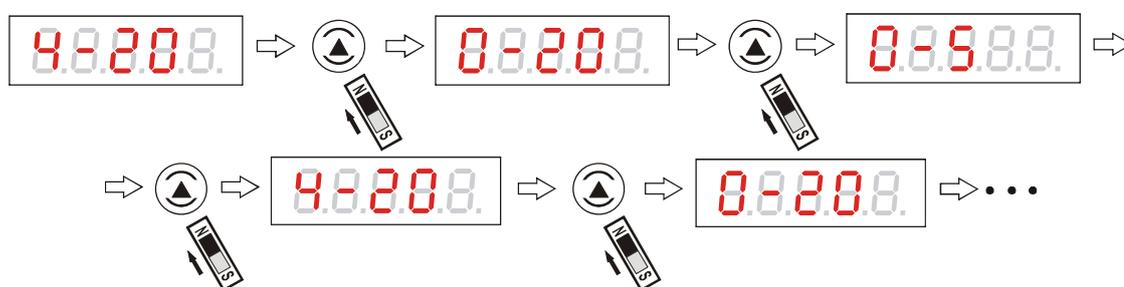
Рисунок 78 - Переход между режимами работы токового выхода
