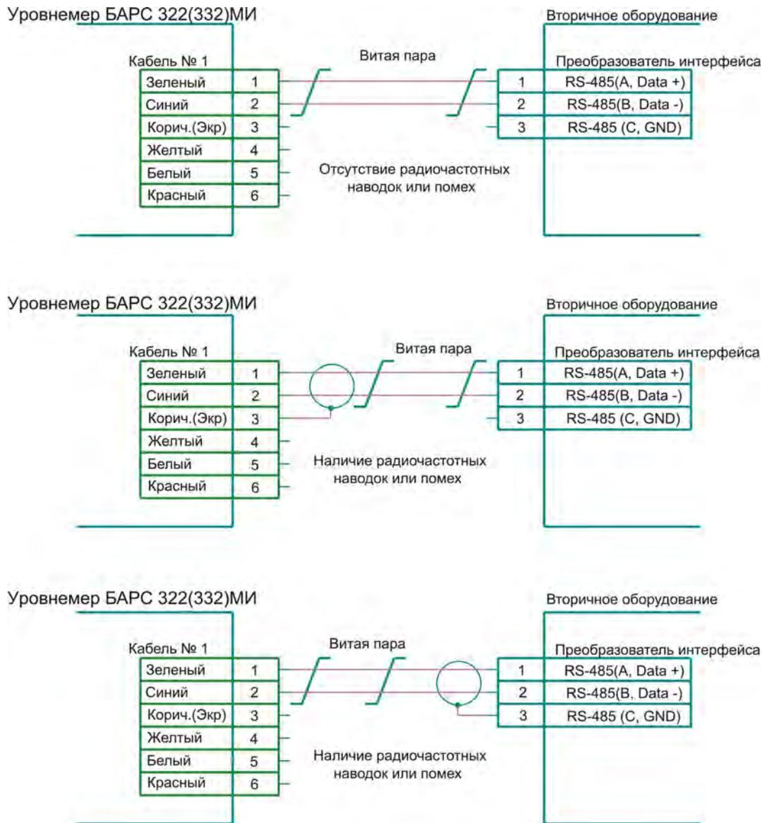
Рисунок Б.1 – Варианты подключения цепей интерфейса RS-485
