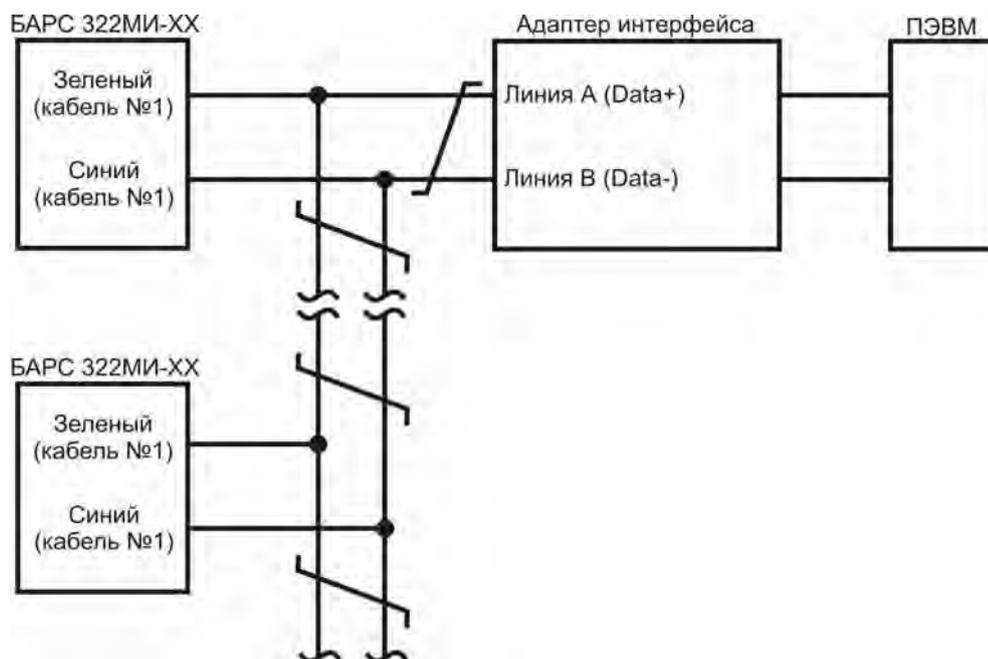
Рисунок 91 - Схема шлейфового соединения цепей интерфейса RS-485
