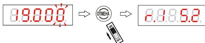
Рисунок 48 - Отмена ввода значения уставки 2 реле 1
