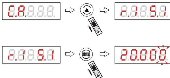
Рисунок 45 - Переход к вводу значения уставки 1 реле 1
