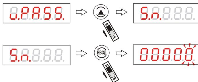
Рисунок 68 - Переход к вводу системного адреса уровнемера
