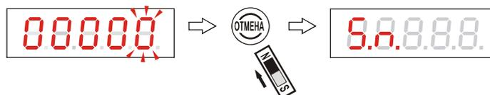
Рисунок 69 - Отмена ввода системного адреса урвнемера
