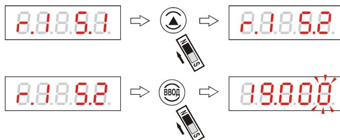
Рисунок 47. Переход к вводу значения уставки 2 реле 1
