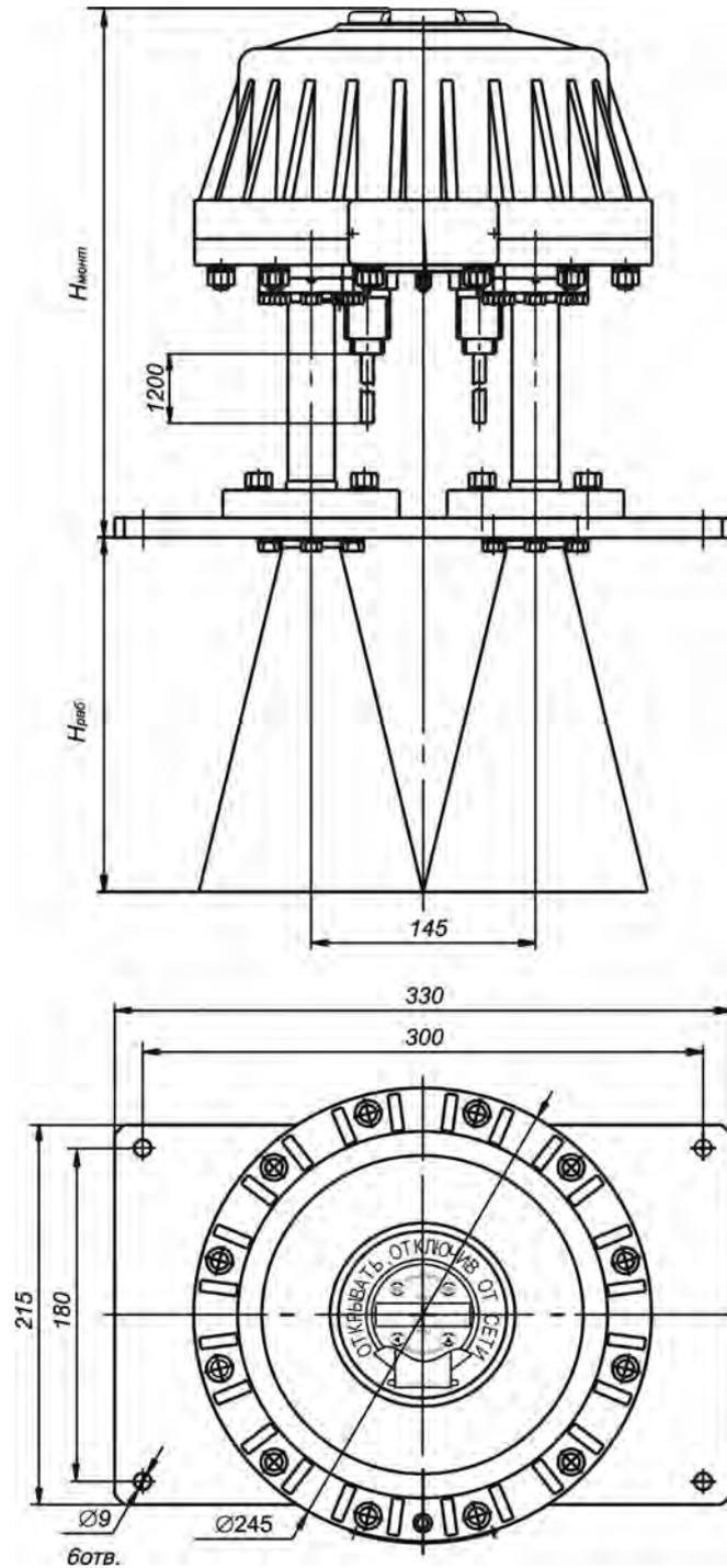
Рисунок 9 - Габаритные и установочные размеры уровня исполнения БАРС 332МИ-02
