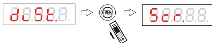
Рисунок 75 - Выход из подраздела выбора режима отображения
