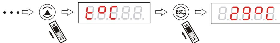
Рисунок 89 - Выбор режима отображения температуры внутри взрывонепроницаемой оболочки
