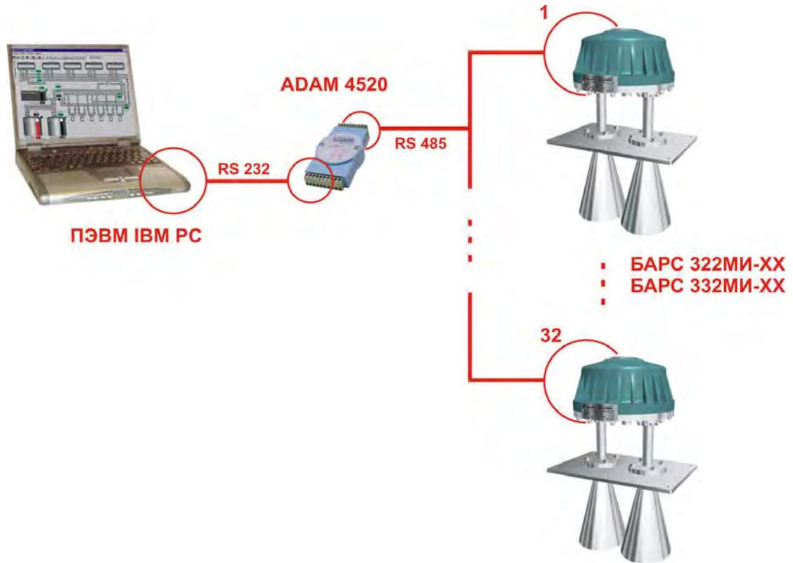
Рисунок 90 - Подключение по линии связи к ПЭВМ
