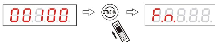
Рисунок 71 - Выход из подраздела просмотра заводского номера урвнемера
