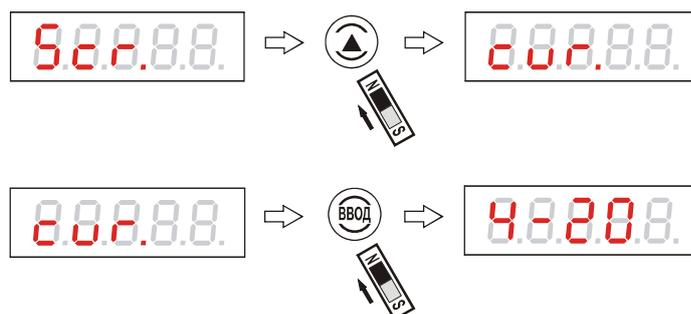
Рисунок 76 - Выбор диапазона токового выхода
