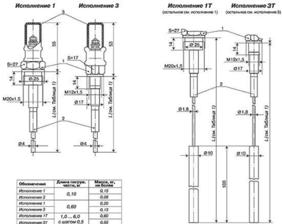
Габаритные и установочные размеры преобразователя передающего ППР-6, ППР-6И
