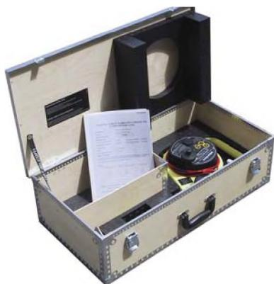
Уровень определяется по градуированной ленте, а температура отображается на ж/к дисплее прибора.
