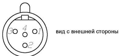
Рис.4. Нумерация контактов гнезда mini-XLR.
