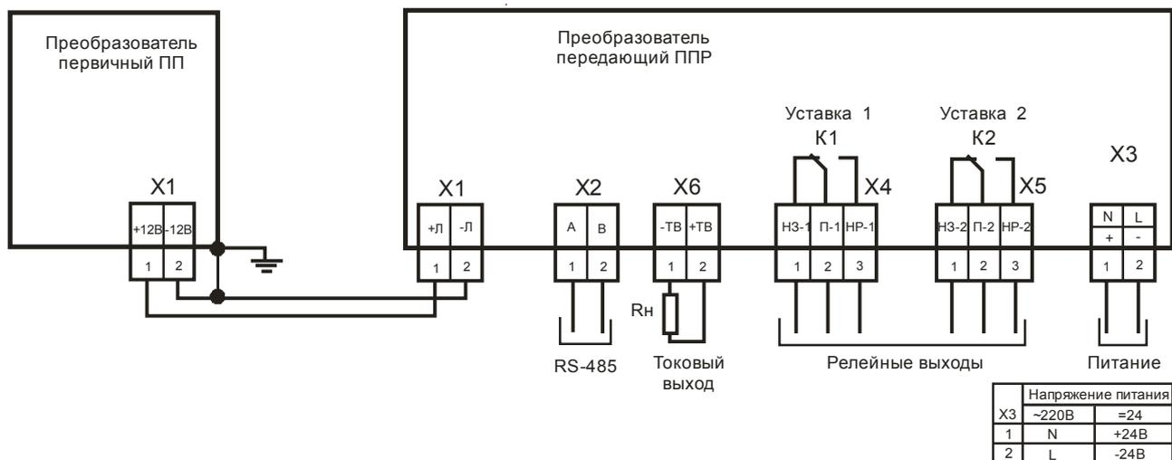
Рис. Г.2 - Схема подключения РИС 121 (невзрывозащищенное исполнение)
