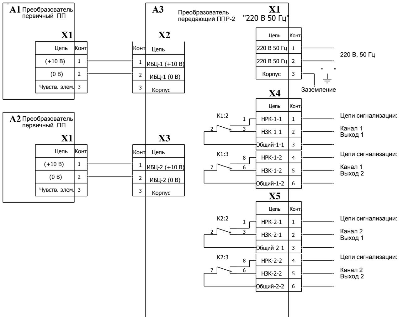
Рис. Л2- Схема подключения РОС 102 (невзрывозащищенное исполнение)
