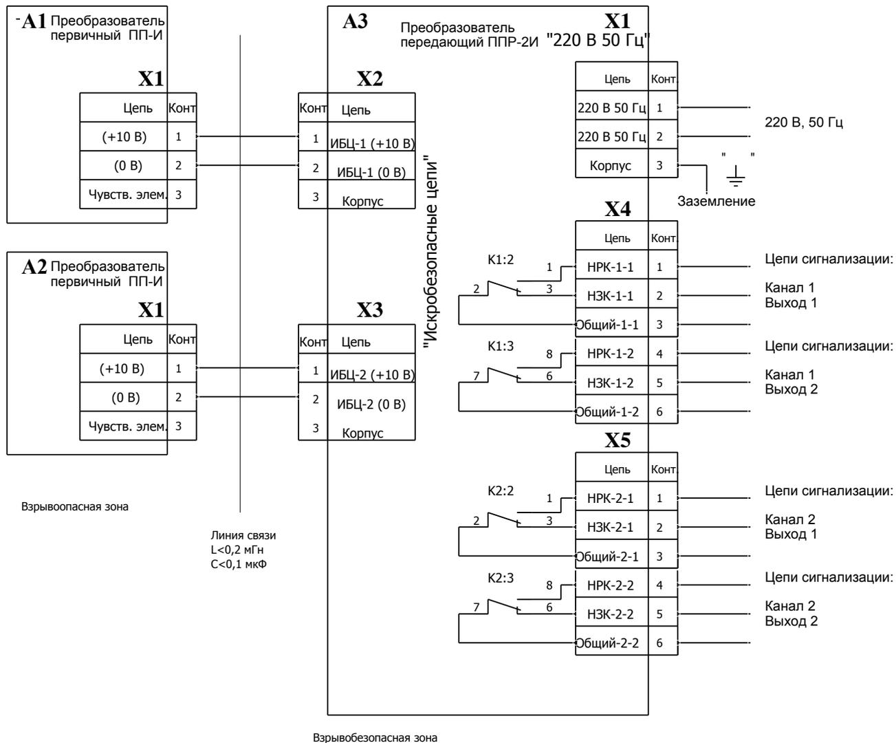
Рис. Л1 - Схема подключения РОС 102-И
