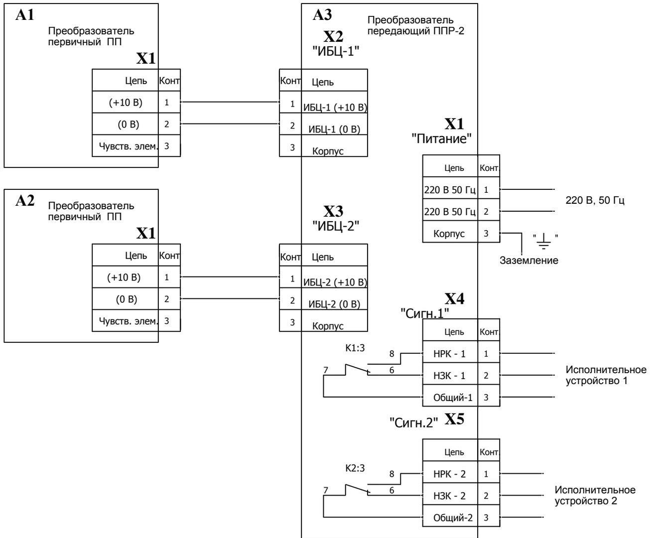
Рис. М3 - Схема подключения СУС-РМ-2 (невзрывозащищенное исполнение)
