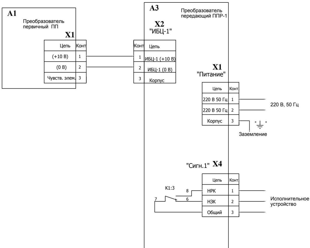
Рис. М4 - Схема подключения СУС-РМ-1 (невзрывозащищенное исполнение)
