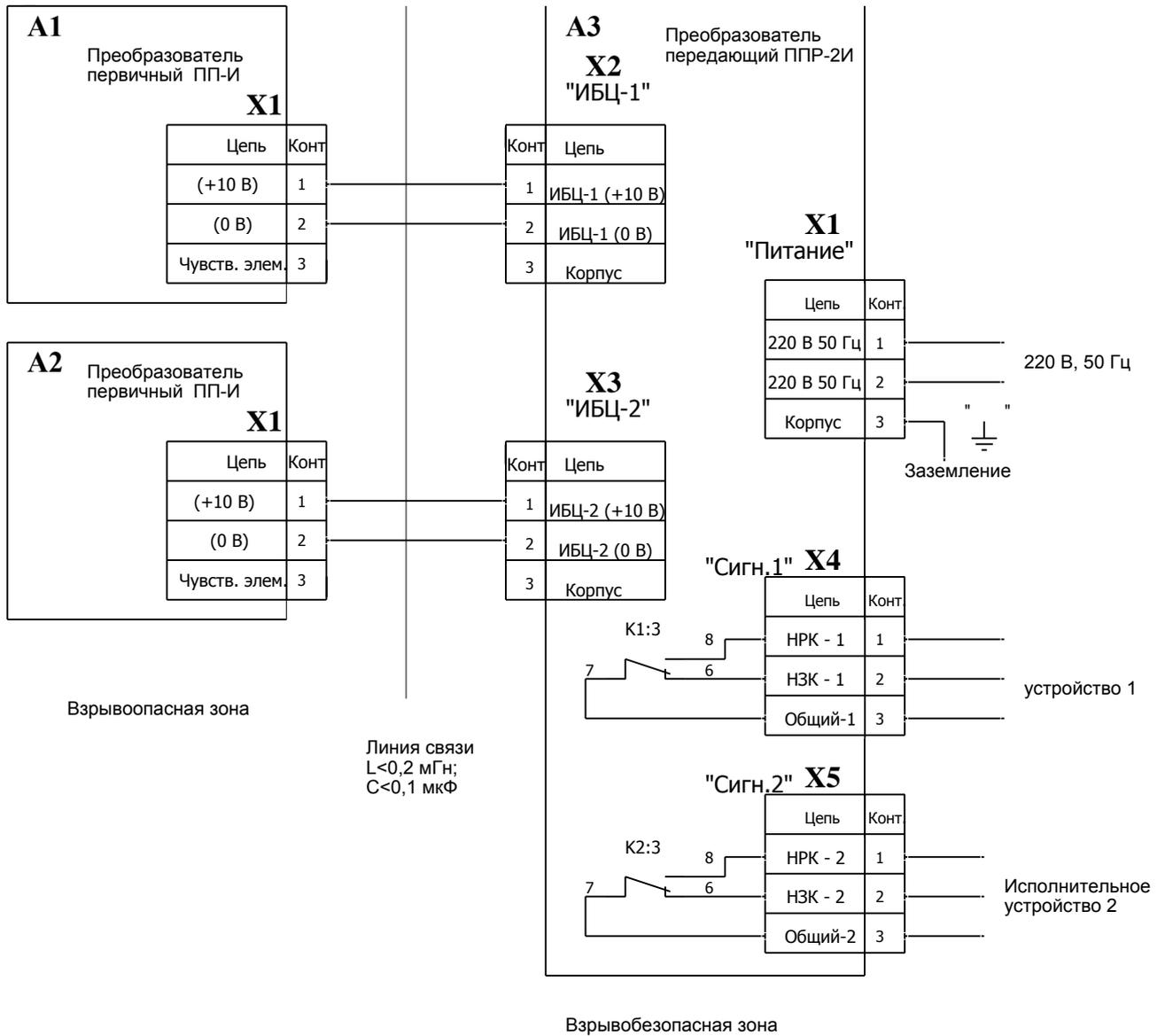
Рис. М1 - Схема подключения СУС-РМИ-2
