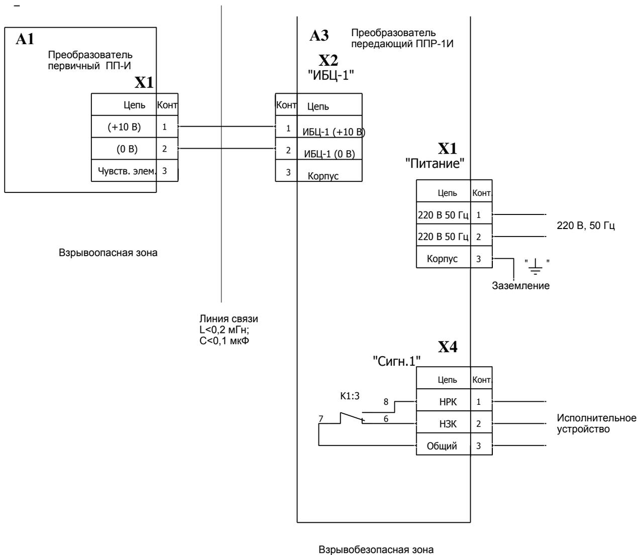
Рис. М2 - Схема подключения СУС-РМИ-1 (взрывозащищенное исполнение)
