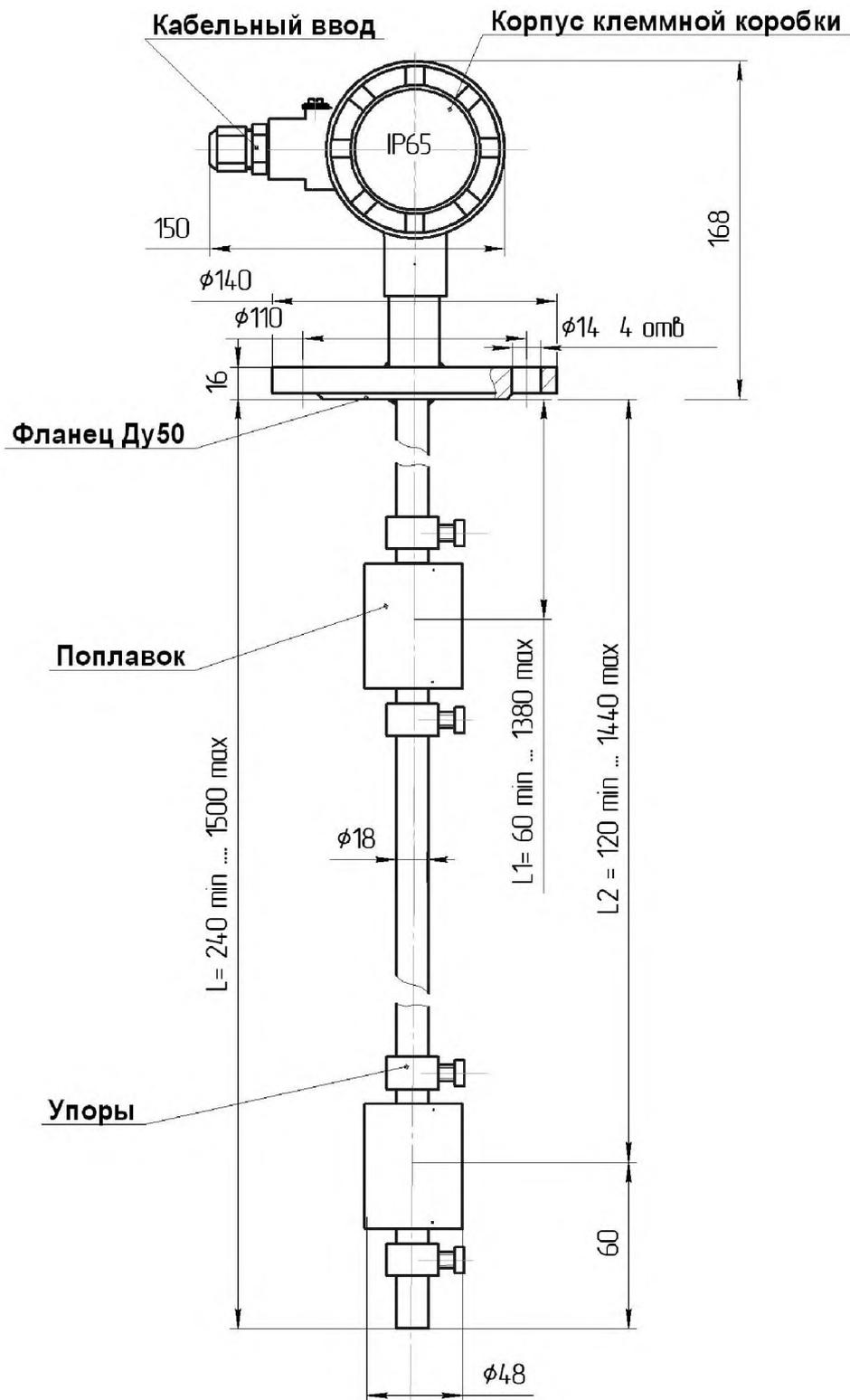
Рисунок А.4 - СУЖ-П-П с двумя поплавками
