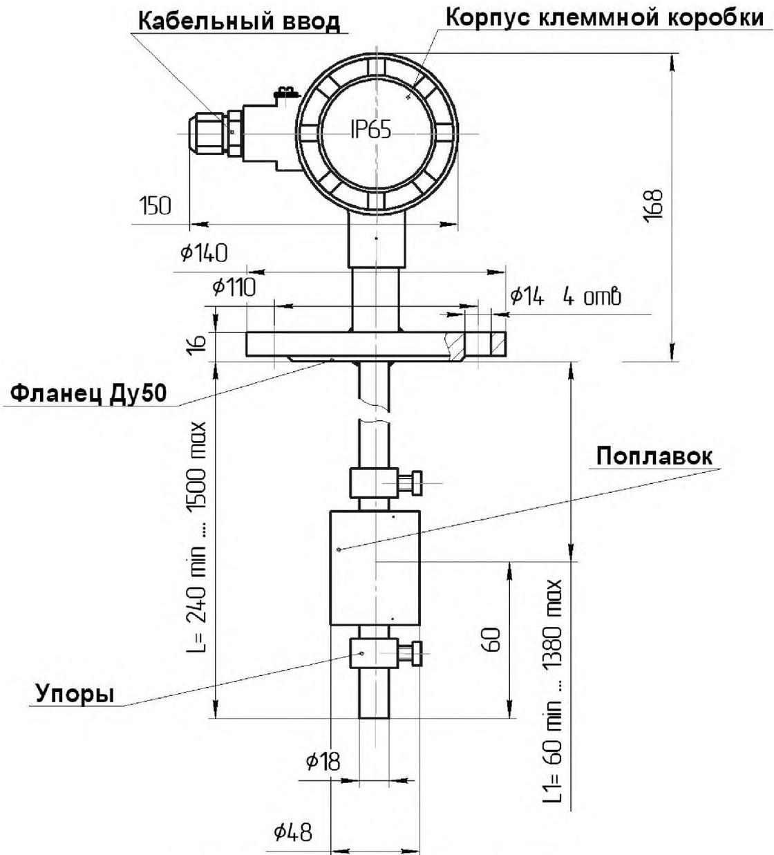
Рисунок А.2 - СУЖ-П-П с одним поплавком
