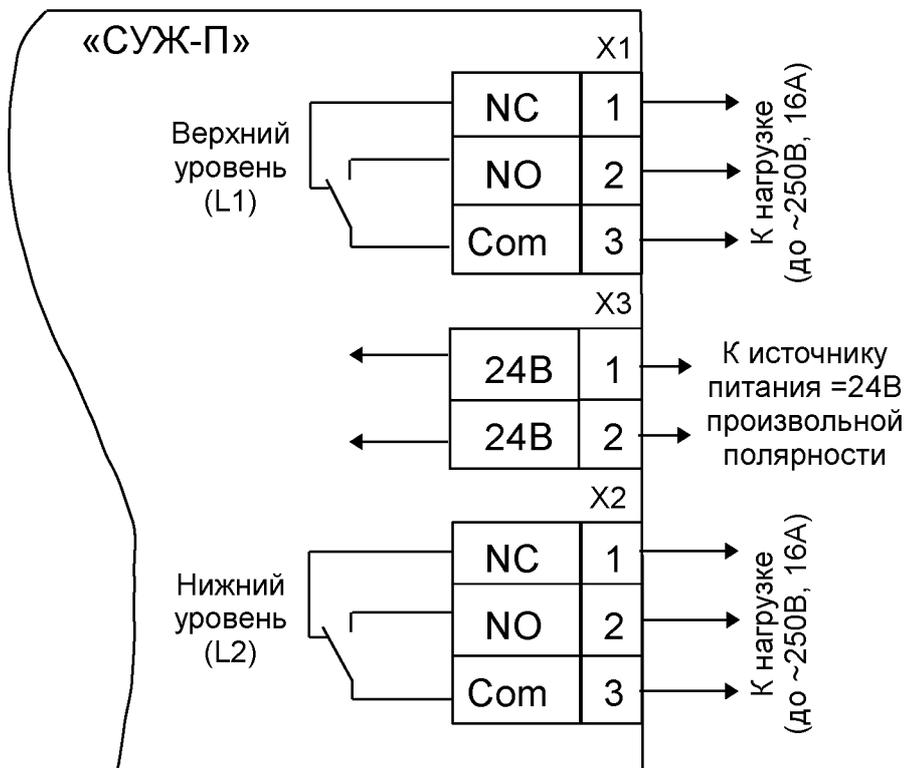
Рисунок В.2 - Подключение сигнализатора со встроенными реле-повторителями
