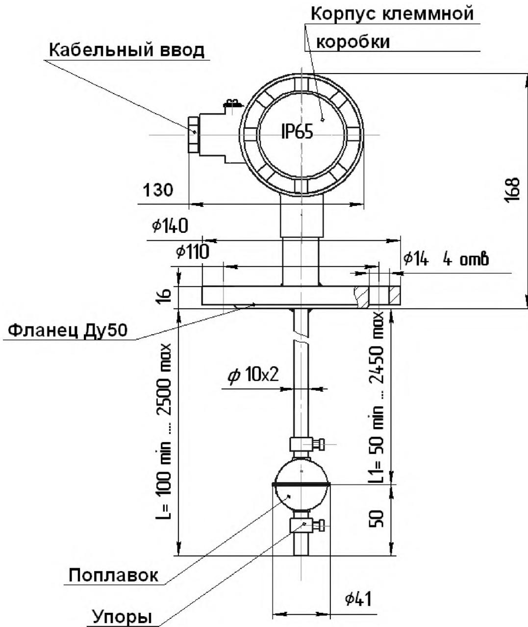
Рисунок А.1 - СУЖ-II-C с одним поплавком
