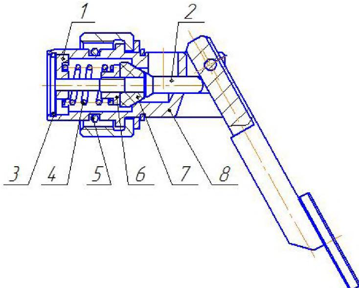
выведете его из корпуса клапана. Выньте из корпуса (8) клапана направляющую втулку (1), пружину (4), толкатель(2) в сборе с конусом (7) и гайкой(6). Затем отвернув гайку (6) заменить конус (7). При необходимости очистить в корпусе (8) контактную фаску клапанной пары используя ветошь.
