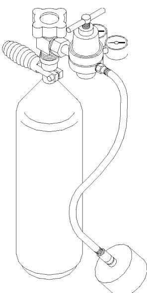
ГБО-2 состоит из баллона, редуктора, ресивера и соединительного шланга. Шланг снабжён соединителем, позволяющим подключать (отключать) газобаллонное оборудование к ресиверу уровнемера.
