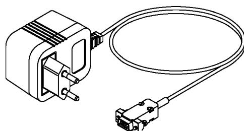
процесса заряда, при напряжении сети от 190В до 240В. При этом на его выходе формируется напряжение постоянного тока 12В с пульсациями не более 1В при токе нагрузки не менее 300mA.
