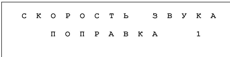
Последовательным нажатием кнопки **ВВОД/ВЫВОД** выберете нужный номер таблицы из числа записанных в приборе. Далее нажатием кнопки **РЕЖИМ** переведите уровнемер в любой требуемый режим работы. Таблица с установленным номером будет рабочей при всех последующих измерениях уровня, вплоть до очередного выбора.
