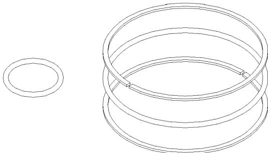
Резиновые уплотнительные кольца ставятся во внешнюю проточку корпуса и в съемное седло клапана и предназначены для замены в случае износа.
