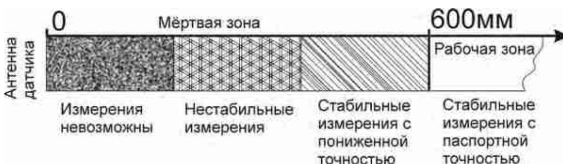
Рис. 4.11. Мертвая зона прибора
