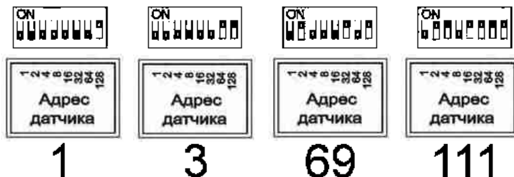
Рис. 6.2. Примеры установки различных адресов
