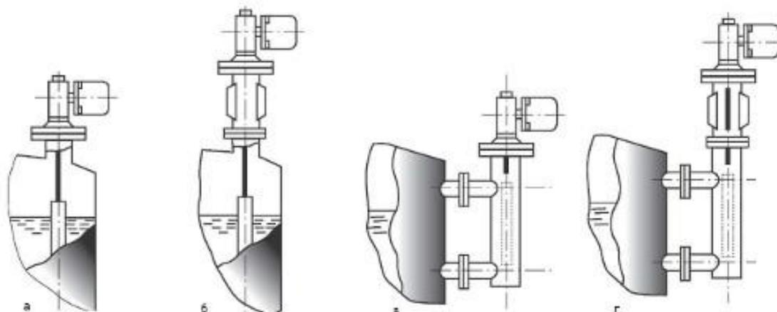
1. установка преобразователя непосредственно на емкости без теплоотводящего патрубка (при температурах контролируемой среды от  $-50$  до  $+120 \text{ }^\circ\text{C}$ );
