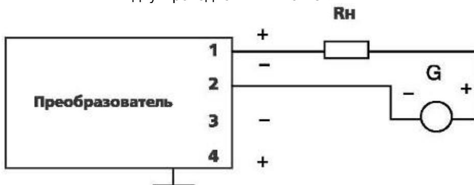
Вариант включения для преобразователей УБ-ЭМ1-Ех с выходным сигналом 4-20 мА при двухпроводной линии связи.
