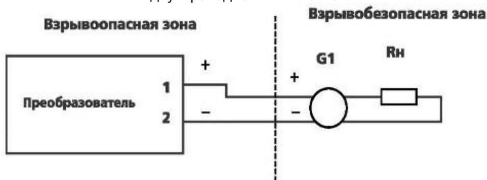
Вариант включения для преобразователей с выходным сигналом 0-5 мА или 0-20 мА или 4-20 мА при четырехпроводной линии связи.
